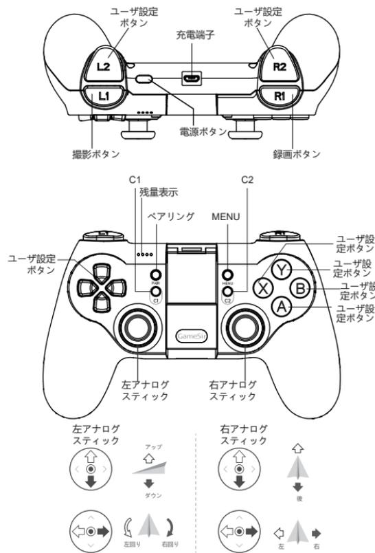
ご注意: コントローラーの出荷時設定コントロール方法は「アメリカハンド」です。左アナログスティックが飛行高度と方向を制御し、右アナログスティックがドローンの前進・後退および左右に飛行する方向を制御します。
