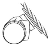
レンズの角度を調整後、貼り付け面の油分や汚れを拭き取り、よく乾燥させた後に、両面テープでしっかりと後部ガラスに貼り付けます。
