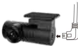
リアカメラの電源端子と付属のリアカメラ接続ケーブルの電源端子を接続します。
