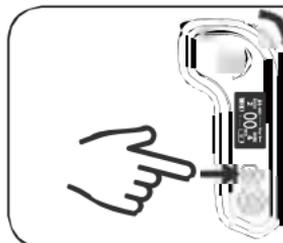
Halten Sie das Gaspedal gedrückt und bleiben Sie in der Bremsposition, und drücken Sie die Funktionstaste einmal, um den Bremsmodus zu ändern.
