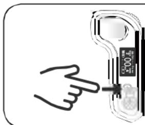
Drücken Sie die Funktionstaste einmal, um die Geschwindigkeitsmodi zu ändern.
