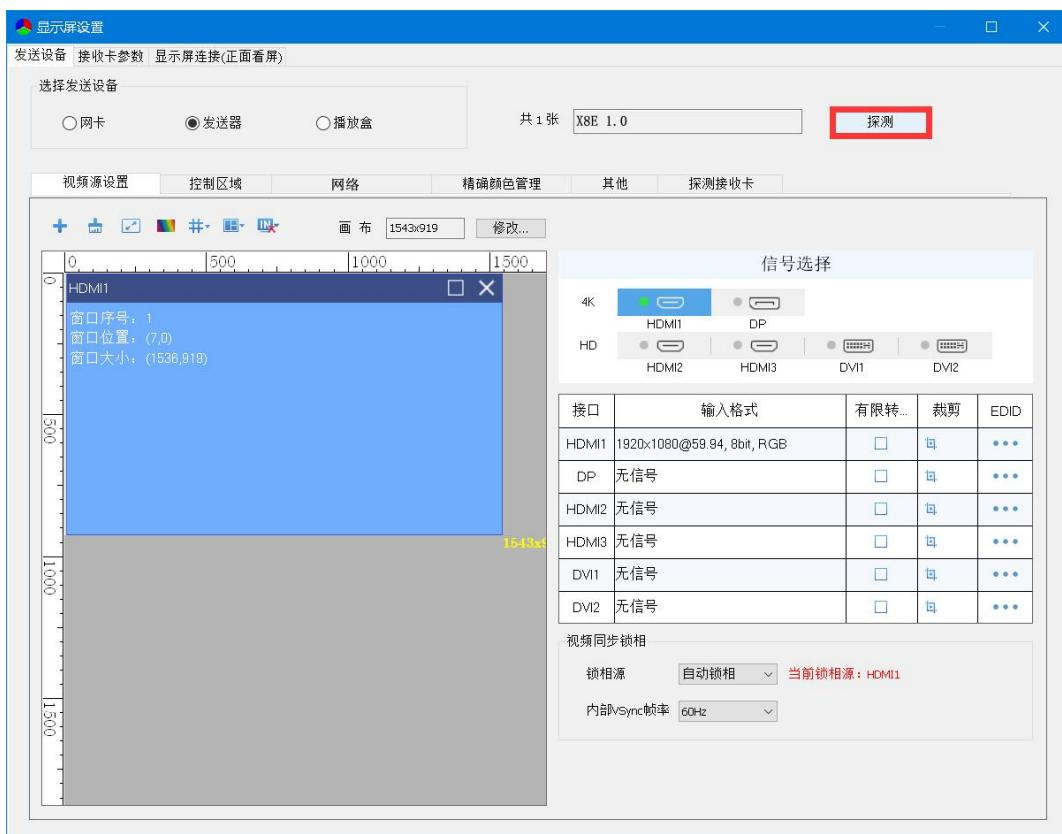
点击【探测接收卡】，进入探测接收卡界面，点击【探测所有接收卡】，接收卡显示区域会显示接收卡所在网口，接收卡序号、版本、运行时间和支持芯片。请确认发送器每个网口带载的接收卡数量是否与实际带载情况一致，如不一致，请检查对应位置的网线。
