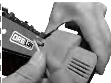
2. Ruota la vite di copertura utilizzando un cacciavite a forma di L per regolare la tensione della catena. Assicurati che ci sia solo uno spazio di circa 0,3 cm quando si tira la catena. Altrimenti, la catena potrebbe staccarsi o bloccare la macchina.
