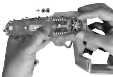
2. Installare la piastra guida e la catena, assicurarsi che la piastra della catena sia orientata correttamente.
