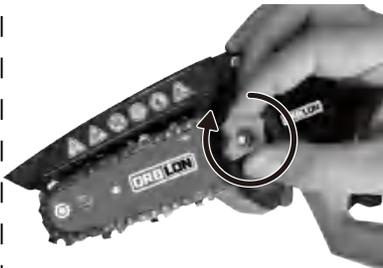
4. Heben Sie den Schutzschild an, legen Sie die Abdeckung auf und ziehen Sie die Abdeckungsmutter im Uhrzeigersinn fest.
