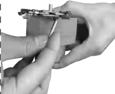
3. Stellen Sie die Position der Befestigungselemente auf dem Schutzschild ein und ziehen Sie die Kette im Voraus fest, um die Installation der Abdeckung zu erleichtern. (Mit L-förmigem Ketten-Schraubendreher)
