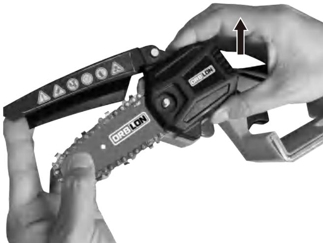
1. Lösen Sie die Abdeckungsmutter gegen den Uhrzeigersinn.
