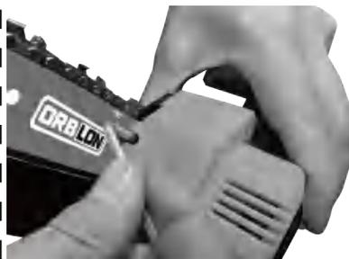
2. Drehen Sie die Abdeckungsschraube mit einem L-förmigen Ketten-Schraubendreher, um die Kettenstraffung einzustellen. Stellen Sie sicher, dass beim Ziehen der Kette nur etwa 0,3 cm Abstand vorhanden ist. Andernfalls kann die Kette herunterfallen oder das Gerät blockieren.
