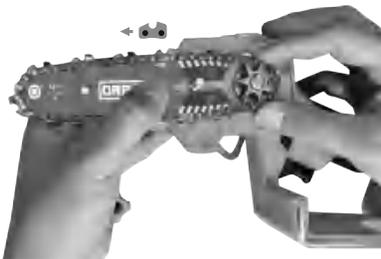
2. Installieren Sie die Führungsschiene und die Kette, stellen Sie sicher, dass die Kettenplatte richtig ausgerichtet ist.
