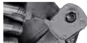
4. fixer la butée de protection à la machine à l'aide de vis (les vis sont incluses dans le kit).
