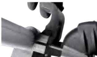
1. réglage de la poignée auxiliaire : Déverrouillez le verrou de fixation, vous pouvez ajuster la position de la poignée auxiliaire à volonté.
