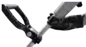
3. réglage de la longueur de la perche : desserrez la fixation de la perche d'extension dans le sens des aiguilles d'une montre pour régler la longueur de la perche, serrez dans le sens inverse des aiguilles d'une montre pour fixer la longueur.
