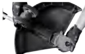
3. enclencher la butée de protection en fonction de la position de la machine, en n'oubliant pas d'enclencher complètement la butée et de la fixer.
