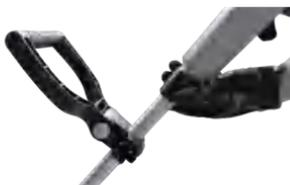
3. Regolazione della lunghezza del palo: allentare la chiusura del palo di prolunga in senso orario per regolare la lunghezza del palo, stringere in senso antiorario per fissare la lunghezza.
