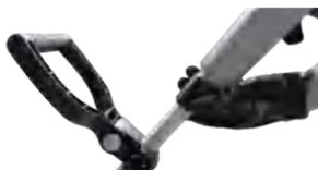
3. Ajuste de la longitud de la pértiga: afloje la fijación de la pértiga extensible en el sentido de las agujas del reloj para ajustar la longitud de la pértiga, apriétela en sentido contrario a las agujas del reloj para fijar la longitud.
