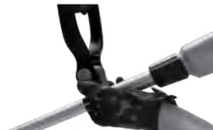
2. Ajuste del ángulo de la empuñadura auxiliar: Pulse el botón de fijación del ángulo para ajustar el ángulo deseado.
