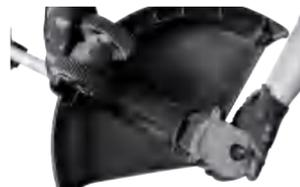
3. Encaje el tope de protección en el lugar correspondiente a la posición de la máquina, recordando encajar completamente el tope y asegurarlo.
