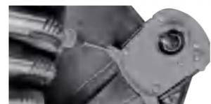
4. Fije el tope de protección a la máquina con tornillos (los tornillos se incluyen en el kit).
