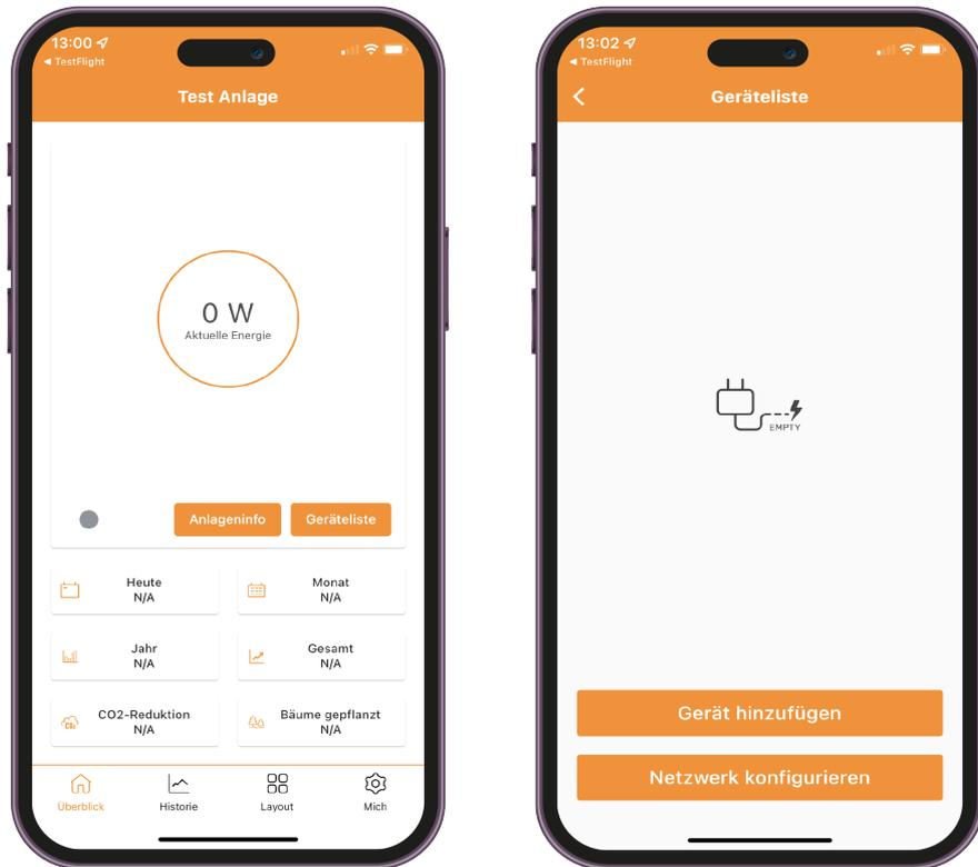
Dann müssen Sie mit der App den QR-Code auf der Rückseite des Wechselrichters scannen. Dafür bitte den extra aufgeklebten Sticker scannen. Danach kann auch schon das Netzwerk konfiguriert werden. Dafür einfach auf **“Netzwerk konfigurieren”** klicken, das Netzwerk wählen und **“Konfig starten”**
