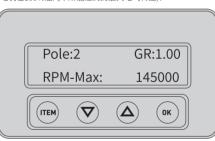
2 主旋翼100%油门转速=MAX RPM ÷ (电机极数÷2)÷齿比 假如电机为10极,电机为10级,电机齿为13T,主齿为120T。即齿比为9.23。
