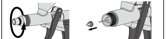
[3] Retirez le capuchon d'aiguille et le capuchon de buse. [4] Retirez la buse.
