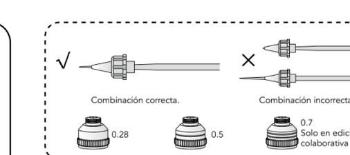
El paquete incluye varios juegos de agujas y boquillas de diferentes tamaños. La combinación incorrecta puede resultar en una exposición excesiva de la aguja o una exposición insuficiente. Por favor, asegúrese de almacenarlos por separado.
