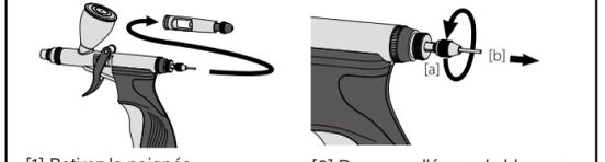
[1] Retirez la poignée. [2] Desserrez l'écrou de blocage de l'aiguille [a], retirez l'aiguille [b].
