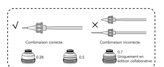
Le paquet comprend plusieurs ensembles d'aiguilles et de buses de différentes tailles. Une correspondance incorrecte peut entraîner soit une exposition excessive de l'aiguille, soit une exposition insuffisante. Veuillez vous assurer de les stocker séparément.
