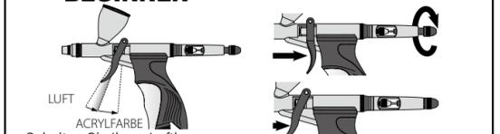
Schalten Sie Ihren Luftkompressor ein. Ziehen Sie Ihren Trigger zurück, um den Luftstrom freizugeben. Ziehen Sie weiter, um den Farbfluss freizugeben. Der voreingestellte Nadel-Feststellschrauber (falls vorhanden) kann den Rückzug des Triggers steuern.
