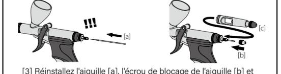
[3] Réinstallez l'aiguille [a], l'écrou de blocage de l'aiguille [b] et la poignée [c], en prenant soin d'éviter de heurter l'extrémité avant de l'aiguille.
