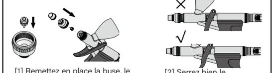
[1] Remettez en place la buse, le capuchon de buse et le capuchon d'aiguille.
