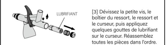
[3] Dévissez la petite vis, le boîtier du ressort, le ressort et le curseur, puis appliquez quelques gouttes de lubrifiant sur le curseur. Réassemblez toutes les pièces dans l'ordre.
