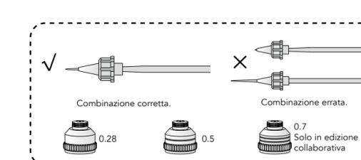
Il pacchetto include più set di aghi e ugelli di diverse dimensioni. L'abbinamento errato può causare un'eccessiva esposizione dell'ago o un'esposizione inadeguata. Si prega di assicurarsi di conservarli separatamente.
