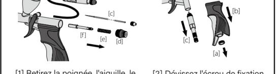
[1] Retirez la poignée, l'aiguille, le guide de fixation de l'aiguille, le ressort et la douille de ressort. [2] Dévissez l'écrou de fixation et la poignée en plastique.
