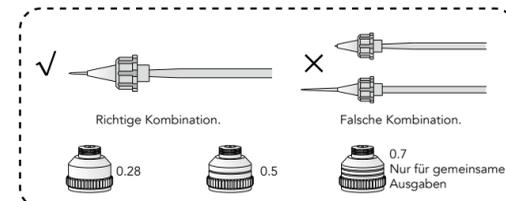
Die Verpackung enthält mehrere Sets von Nadeln und Düsen in verschiedenen Größen. Falsche Zuordnung kann entweder zu übermäßiger Nadelbelichtung oder unzureichender Belichtung führen. Bitte stellen Sie sicher, sie getrennt aufzubewahren.
