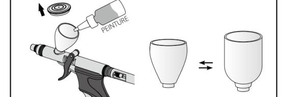
Mettez quelques gouttes de peinture dans le godet, diluez la peinture pour qu'elle ressemble à du lait si nécessaire avant de la verser dans le godet. Cet aérographe peut être équipé de réservoirs de différentes capacités pour répondre à divers besoins de pulvérisation.
