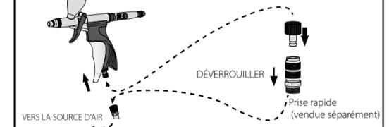
Commencez par fixer l'extrémité d'un tuyau d'aérographe (1/8" BSP) à votre aérographe. Attachez la partie mâle à l'aérographe et la partie femelle à la source d'air, tirez vers le bas pour déverrouiller.
