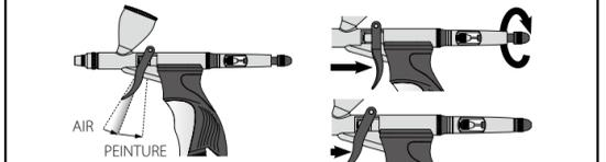
Allumez votre compresseur d'air. Tirez sur le trigger pour libérer le flux d'air, continuez à tirer pour libérer le flux de peinture. La molette de contrôle de fluide pré-réglée (si équipée) peut contrôler la rétraction du trigger.
