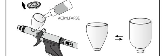
Geben Sie ein paar Tropfen Acrylfarbe in den Fließfarbbehälter, verdünnen Sie die Farbe bei Bedarf, damit sie wie Milch aussieht, bevor Sie sie in den Becher gießen. Dieser Airbrush kann mit Behältern unterschiedlicher Kapazität ausgestattet werden, um verschiedenen Sprühbedürfnissen gerecht zu werden.
