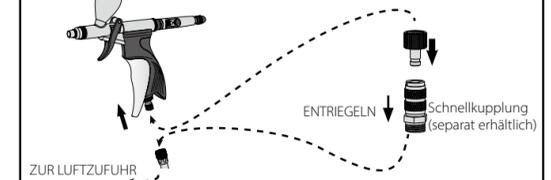
Befestigen Sie das Ende eines Airbrush-Schlauchs (1/8" BSP) an Ihrem Airbrush. Befestigen Sie den männlichen Teil am Airbrush und den weiblichen Teil an der Luftzufuhr, ziehen Sie nach unten, um zu entriegeln.
