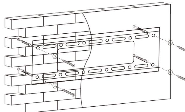
Passo 2- Supporto di montaggio sul televisore
