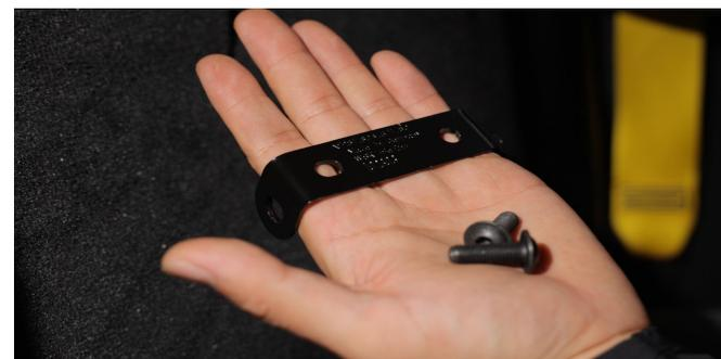
2. 使用T40套筒，万向转接头，延长杆和3/8扳手，将安全带肩部固定支架套件的固定支架和短螺栓，固定到安装孔上。
