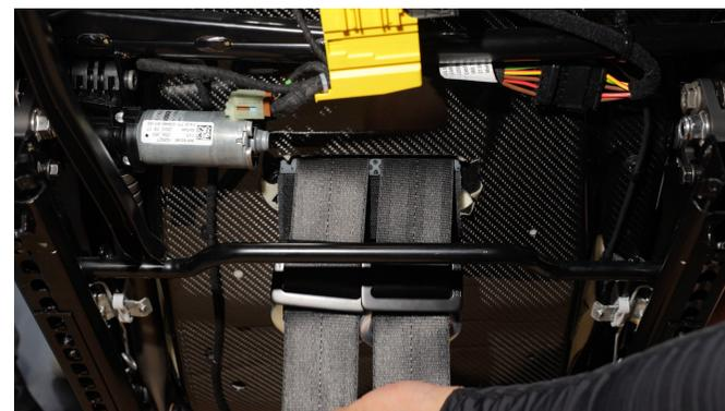
2. 将放置好六点式安全带底部绑带的座椅，放回座舱内。
