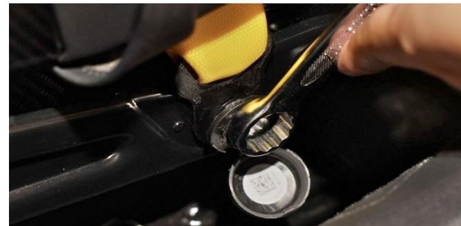
2. 使用E12套筒搭配3/8扳手及延长杆拆下座椅两侧导轨的四个座椅螺栓，你可以通过前后滑动座椅以便更好接触到螺栓。
