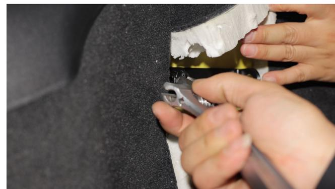
4. 使用15毫米套筒和15毫米扳手，将安全带肩部固定支架套件的长螺栓，放入铝管中，完成固定。
