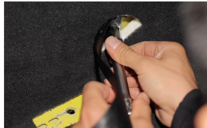
2. 另一侧使用同样的方法, 将六点式安全带腰部绑带, 固定在座舱侧面的安装孔上。
