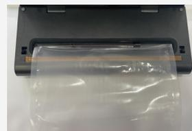
4. Fermez et appuyez fermement sur le couvercle avec 2 mains des deux côtés du couvercle pour mettre la machine en position verrouillée. Vous entendrez 2 "clics" si la machine est correctement verrouillée.
