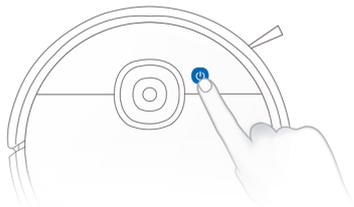
**Remarque :** Le panneau de commande du robot s'éteint lorsque le robot est mis en pause depuis quelques minutes. Appuyez sur le bouton Mode AUTO du robot pour le réactiver.
