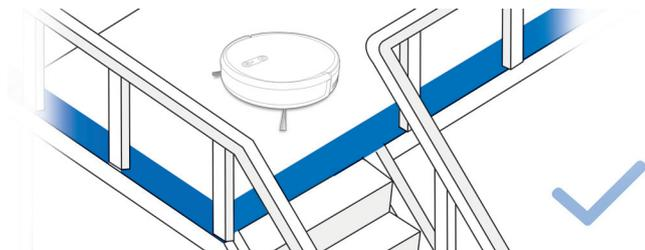
Potrebbe essere necessario posizionare delle barriere sul bordo del dislivello per evitare la caduta del robot.
