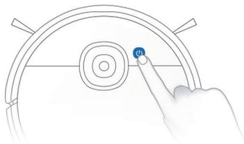
**Nota:** El panel de control del robot se apaga tras dejarlo en pausa durante unos minutos. Pulse el botón del modo automático del robot para reactivarlo.
