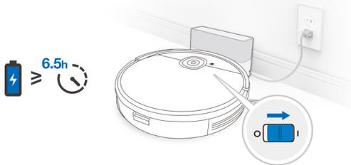
**Hinweis:** Nach Beendigung des Reinigungsvorgangs oder bei niedrigem Akkuladestand kehrt der Roboter zum Aufladen automatisch zur Dockingstation zurück. Der Roboter kann auch jederzeit über die yeedi-App oder durch Drücken der AUTO-Taste am Roboter für 3 Sekunden zur Dockingstation zurückgebracht werden.
