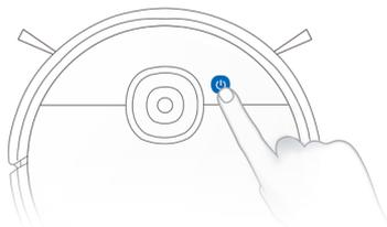
**Hinweis:** Das Bedienfeld des Roboters hört auf zu leuchten, wenn der Roboter mehrere Minuten pausiert. Drücken Sie die Taste AUTO-Modus am Roboter, um den Ruhemodus des Roboters zu beenden.
