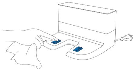
**Hinweis:** Schalten Sie vor der Reinigung der Ladekontakte des Roboters und der Steckkontakte der Dockingstation den Roboter AUS, und trennen Sie die Dockingstation vom Netz.
