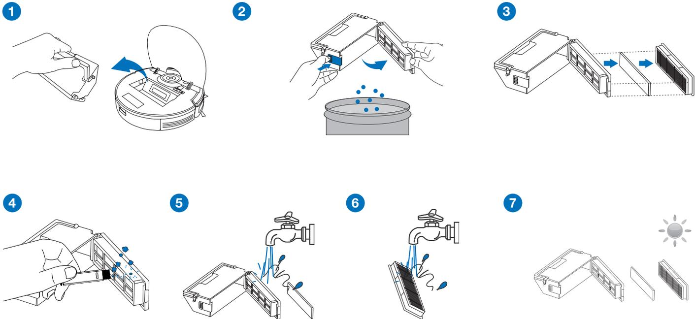
**Hinweis:** 1. Spülen Sie den Filter wie oben gezeigt mit Wasser aus. 2. Reinigen Sie den Filter nicht mit dem Finger oder einer Bürste. 3. Lassen Sie den Filter nach der Reinigung mindestens 24 Stunden lang trocknen.
