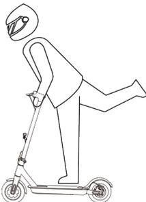
Wenn der Roller zu rollen beginnt, stellen Sie beide Füße auf das Deck und drücken Sie das Gaspedal (das Gaspedal leitet einmal die Ausrollgeschwindigkeit ein).
