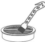
6. Faites pivoter le filtre en acier inoxydable dans le sens des aiguilles d'une montre pour le retirer du support du filtre.
