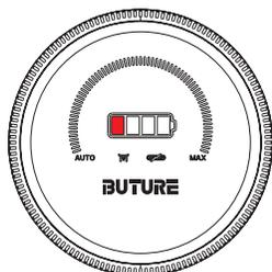
2. **Después de apagar la aspiradora**, el indicador de la batería parpadea en naranja, luego parpadea lentamente durante 5s y se apaga, lo que indica que la energía es menos del 25%, por favor, cárguela a tiempo.
