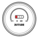
2. **Nach dem Ausschalten des Staubsaugers** blinkt die Batterieanzeige orange, dann blinkt sie langsam für 5 Sekunden und erlischt, was anzeigt, dass die Leistung weniger als 25 % beträgt, bitte laden Sie sie rechtzeitig auf.
