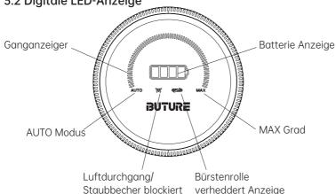
Tipp: Das """ " Symbol wird nur angezeigt, wenn der Staubsauger blockiert ist.
