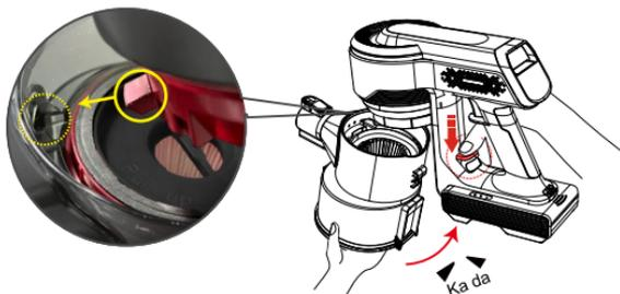
**Nota:** La función del elemento filtrante de aire es permitir que la máquina disipe el calor y drague el aire de manera más eficaz durante el funcionamiento, sin necesidad de una limpieza frecuente. Si es necesario, pulse el botón de liberación del filtro de aire para retirarlo.
