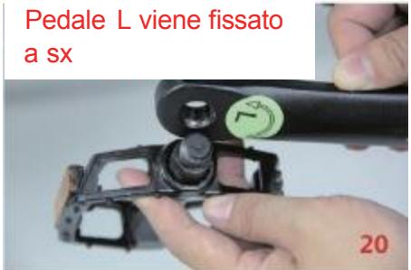
Girare il pedale L nel senso anti-orario ed avitarlo
