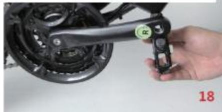
Drehen Sie das Pedal R im Uhrzeigersinn und befestigen Sie es
