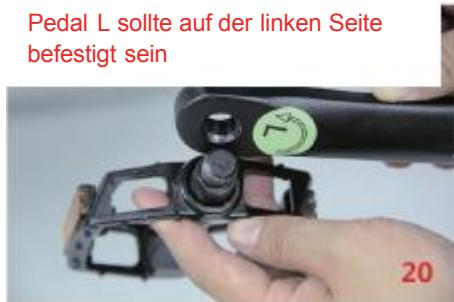
Drehen Sie das Pedal L gegen den Uhrzeigersinn und befestigen Sie es
