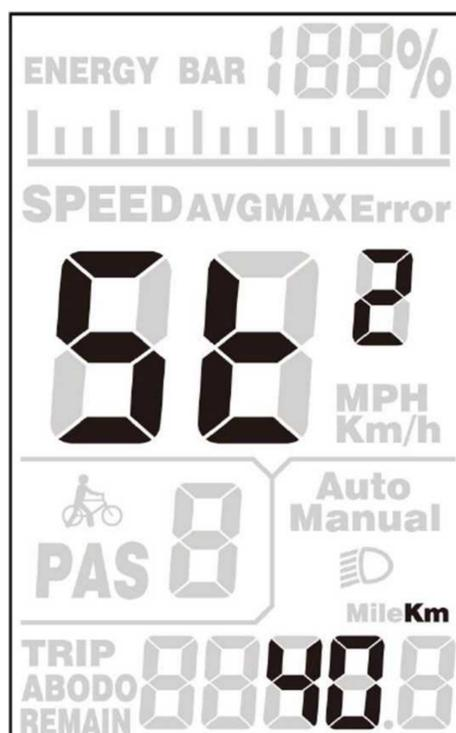
Interfaccia per l'impostazione del limite di velocità
