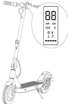
1. Schalten Sie das Gerät ein und überprüfen Sie den Strom Indikator.
