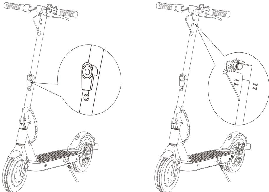
1. Klappen Sie den Vorbau aus und schließen Sie den Klappriegel, bis Sie hören ein Klicken. Klappen Sie dann den Ständer auf, um den Roller unterstützen.
