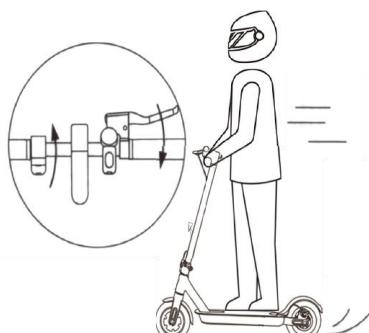
4. Lassen Sie den Beschleuniger und die kinetische Energie los Wiederherstellungssystem (KERS) startet automatisch, um langsam bremsen; Und drücke den Bremshebel für ein plötzliches Bremsen.
