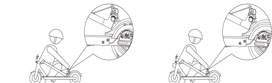
Stellen Sie sicher, dass der Roller ausgeschaltet ist. Zum Zusammenklappen den Klappmechanismus entriegeln und den Lenkervorbaus biegen, um die Schnalle am hinteren Kotflügel einzuhaken. Zum Öffnen den Glockenauslöser drücken, um ihn aus der Schnalle zu entfernen, den Lenker aufrichten und die Klappstruktur verriegeln.
