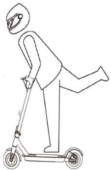
Wenn der Roller zu rollen beginnt, stellen Sie beide Füße auf das Deck und drücken Sie das Gaspedal (das Gaspedal leitet einmal die Ausrollgeschwindigkeit ein).
