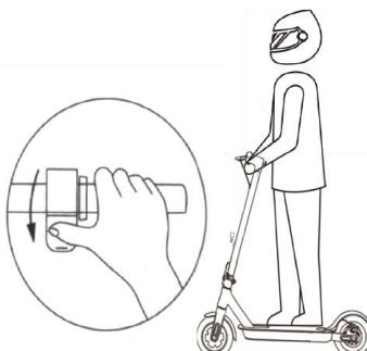
3. Wenn der Roller zu rollen beginnt, legen Sie beide Füße auf dem Deck und Gas geben (das Gaspedal leitet ein, sobald das Ausrollen Geschwindigkeit überschreitet 5 km/h).
