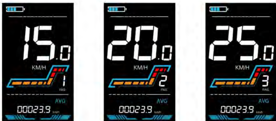
Figure 5-4 PAS level display interface
