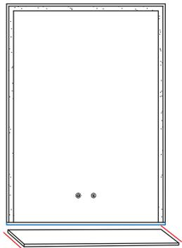
2. Setzen Sie die Glasablage in den Metallrahmenschlitz an der vorderen Unterseite des Spiegels ein.
