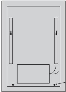
1. Hängen Sie den Spiegel an die Wand. Suchen Sie die sicheren Schrauben an der hinteren Unterseite des Spiegelrahmens und lösen Sie die Schrauben durch Drehen der Knöpfe.
