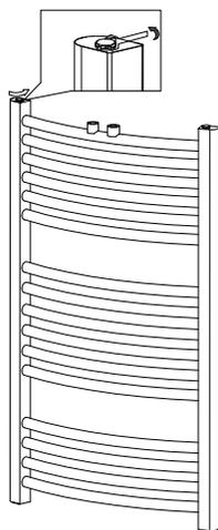
**Schritt 2:** Schrauben Sie das Heizelement mit dem Schraubenschlüssel fest auf den Heizkörper (im Uhrzeigersinn).
