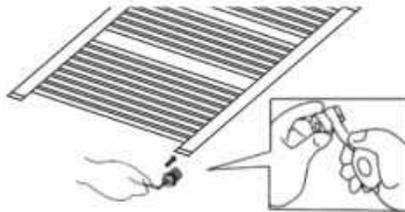
3. Schrauben Sie die Endungen der Heizkörperventile (nicht im Lieferumfang enthalten) in die unteren 2 Gewinde. PTFE-Band auftragen.
