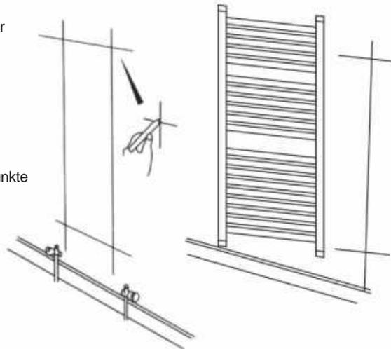
5. Montage am Backstein oder Brisenmauer
