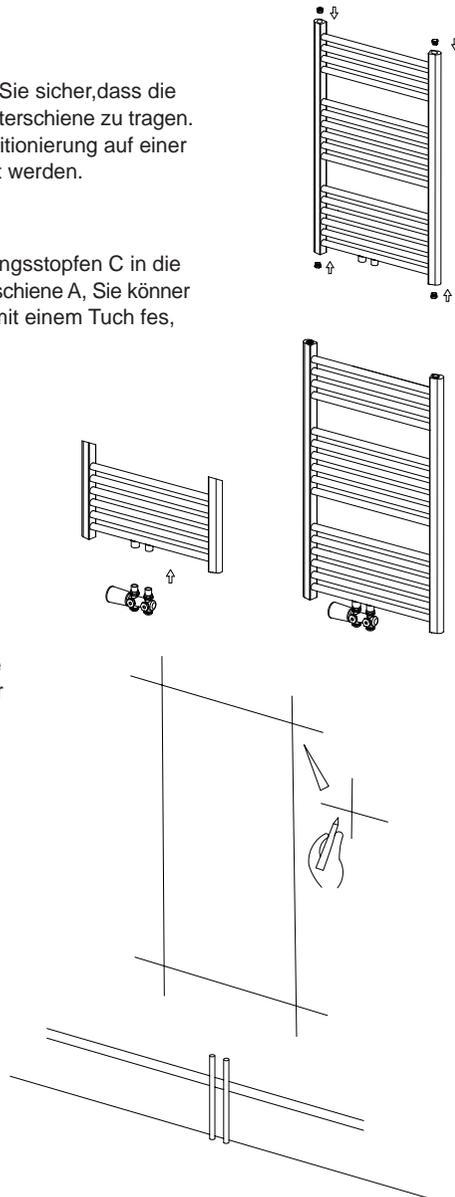
5. Montage am Backstein oder Brisenmauer Bohren Sie an den gewünschten Befestigungspositionen das Loch mit einem 8mm Steinbohrer und setzen Sie den Wandstopfen E so in das Loch ein dass er bündig mit der Wand abschließt. Setzen Sie die lange Schraube F durch die Mitte der Wandhalterung D und ziehen Sie die am Dübel fest.
