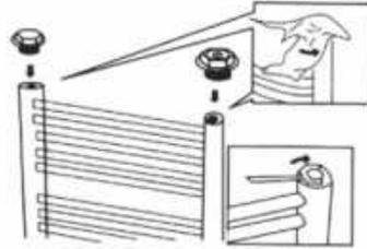
2. Schrauben Sie den Blindstopfen B und den Entlüftungsstopfen C in die oberen 2 Gewinde der senkrechten Kanäle der Leiterschiene A, Sie können auf beiden Seiten montiert werden. Ziehen Sie sie mit einem Tuch fest, um Kratzer zu vermeiden. PTFE-Band auftragen.
