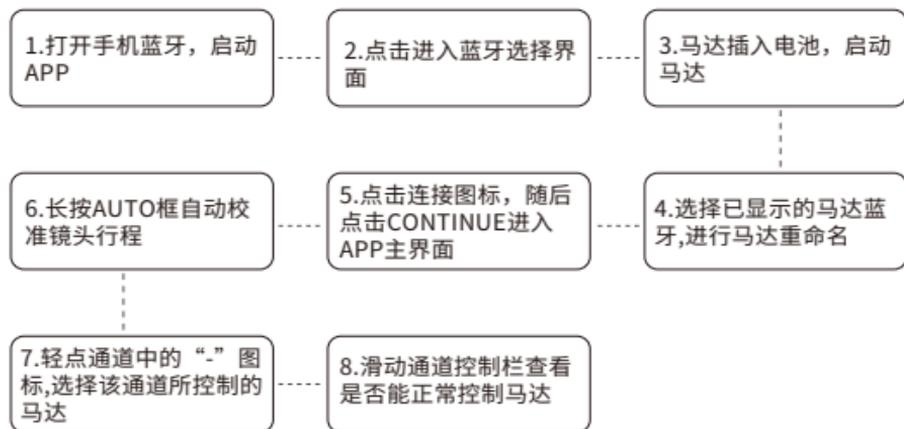
如需连接多个蓝牙马达，请重复进行第3和4步。第6步自动校准镜头行程也可以替换为手动校准镜头行程进行校准。
