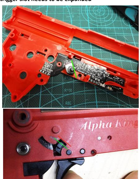
适当在滑块轴上套垫片,确保滑块和下波壳之间贴紧没有缝隙,防止漏光,图中绿色箭头处如和波箱之间有缝隙建议放置垫片
