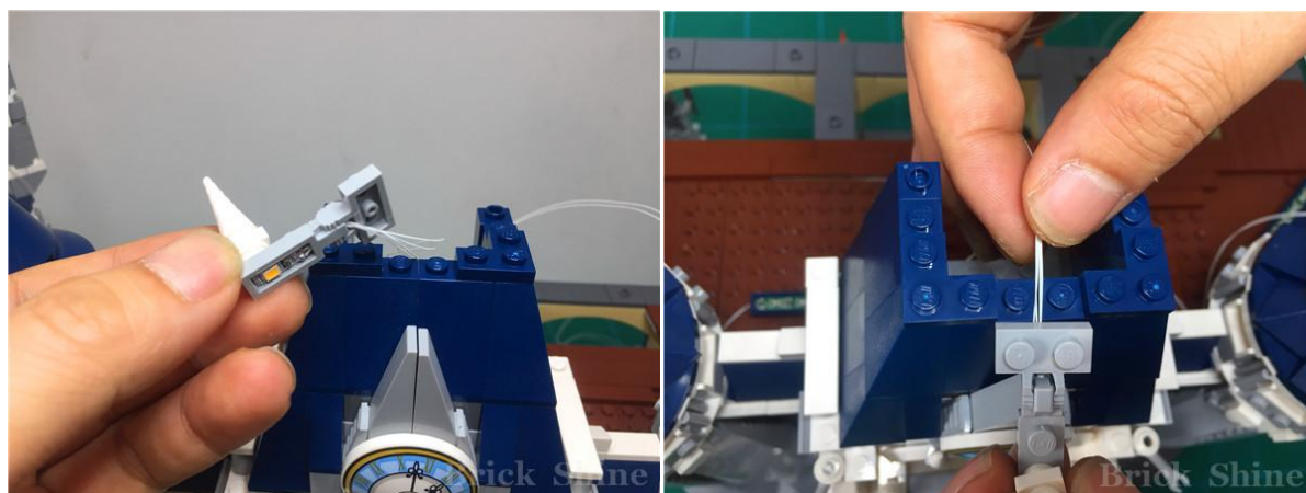
出线口的导线沿着深蓝色零件凸起之间的缝隙通过
