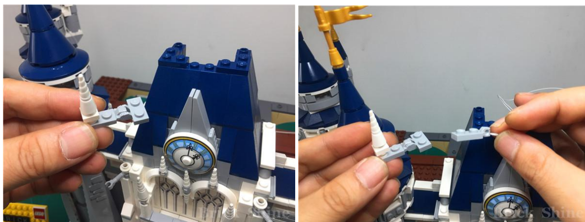
出线口的导线沿着深蓝色零件凸起之间的缝隙通过
