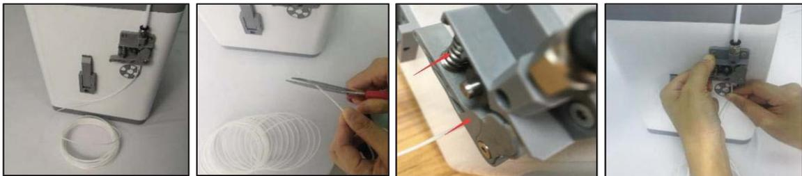
Premere la manopola per iniziare a caricare il filamento. Una volta che il filamento inizia a estrudere dall'u u gello, premere di nuovo la m anopola per arrestare l'estrusione; quindi premere la m anopola per selezionare l'opzione Continue
