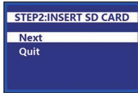
3: Drücken Sie den Drehknopf, um Von SD drucken auszuwählen. Drehen Sie den Drehknopf, um eine Datei mit dem Format .gcode auf der microSD-Karte auszuwählen, und drücken Sie dann den Drehknopf, um den Druckvorgang für das ausgewählte Modell zu beginnen.
