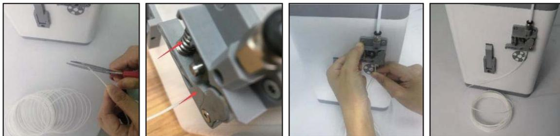
Presione la perilla para comenzar a cargar el filamento. Una vez que el filamento empiece a extrudirse por la boquilla, pulse de nuevo la perilla para detener la extrusión, luego pulse la perilla para seleccionar la opción Continuar.
