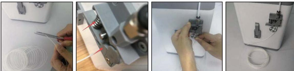
Appuyez sur le bouton pour commencer à charger le filament. Une fois que le filament commence à sortir de la buse, appuyez à nouveau sur le bouton pour arrêter l'extrusion, puis appuyez sur le bouton pour sélectionner l'option Continuer.
