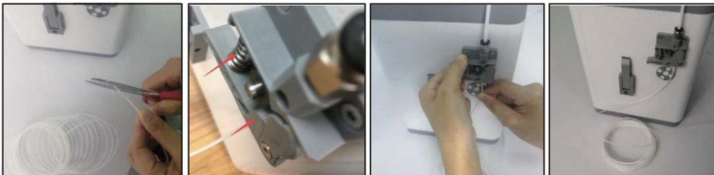
Drücken Sie den Drehknopf, um mit dem Laden des Filaments zu beginnen. Sobald die Düse beginnt Filament zu extrudieren, drücken Sie den Drehknopf erneut um die Extrusion zu stoppen, drücken Sie anschließend den Drehknopf, um die Option Fortfahren auszuwählen
