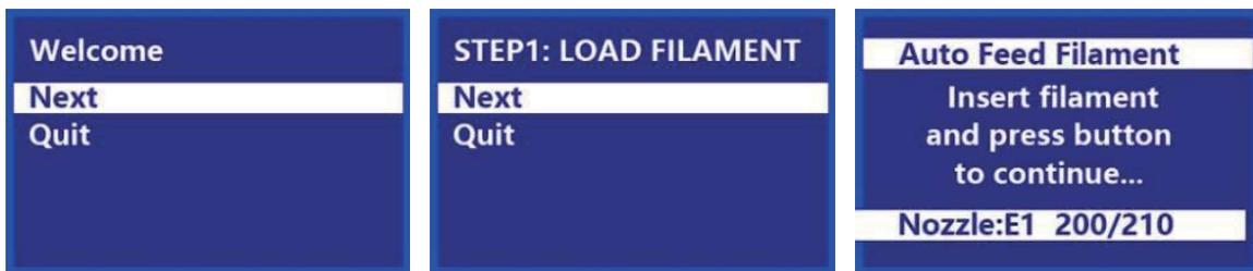
À l'aide d'une paire de ciseaux ou de pinces coupantes, coupez l'extrémité du filament d'environ un pouce, puis redressez doucement l'extrémité du filament. Serrez le levier de l'extrudeuse, insérez le filament dans le fond jusqu'à ce que vous rencontriez une résistance, puis relâchez le levier.
