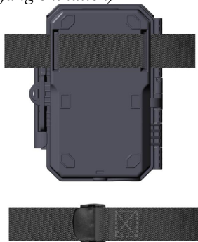
Abb.8: Montage der Kamera
