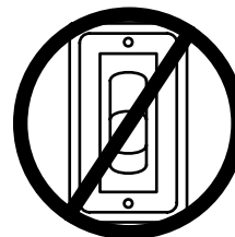
Aucun contrôle de mur à vitesse variable
