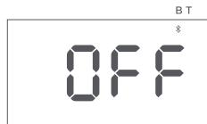
Bluetoothマークが表示するまで操作メーターのボタンを押します。ボタンを長押しすると、Bluetoothが切斷されます。Bluetoothの表示が「OFF」となります。
