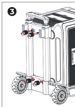
3) Как показано на рисунке: пропустите винт через прицеп в указанном направлении и закрепите машину на прицепе.
