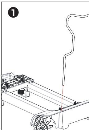
1) Como se muestra en la imagen: inserte la varilla de soporte en el asiento del remolque.
