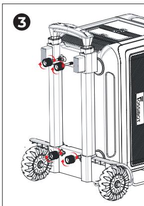
3) Como se muestra en la imagen: pase el tornillo a través del remolque en la dirección mostrada y fije la máquina en el remolque.
