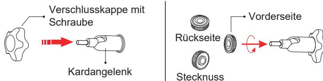
3. Schrauben Sie das Kardangelenk auf der Rückseite des Solarmoduls ein. Ziehen Sie es mit der beigelegten Mutter fest an.
