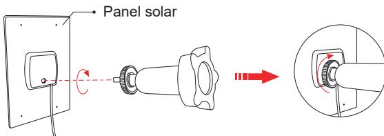
4. Atornille el tapón de rosca de cierre en la base. Asegúrese de que la junta universal esté orientada hacia arriba.
