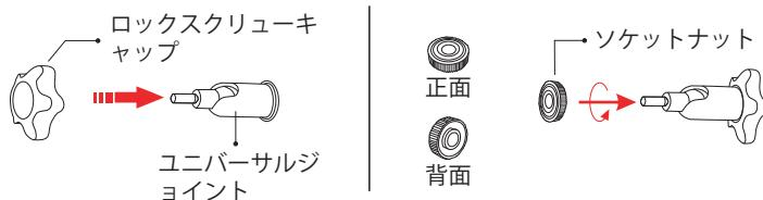
3.ユニバーサルジョイントをソーラーパネルの背面にねじ込んでください、付属のナットでしっかりと締め付けてください。
