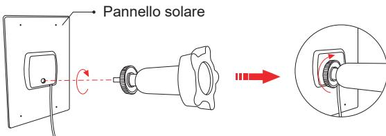
4. Avvitare il cappuccio della vite di bloccaggio nella base. Assicurarsi che il giunto universale sia angolato verso l'alto.
