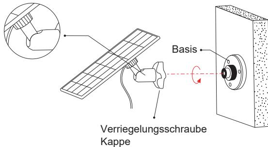
5. Wenn Sie das Solarpanel nach links oder rechts verstauen möchten, lösen Sie die Verschlusskappe, drehen Sie die Hülsenstange und ziehen Sie die Verschlusskappe wieder an, wenn sich das Panel in der gewünschten Position befindet.
