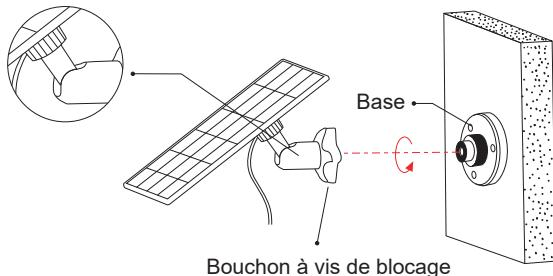
5. Pour ajuster le panneau solaire à gauche ou à droite, desserrez le bouchon de la vis de blocage, tournez la tige du manchon et resserrez le bouchon de la vis de blocage lorsque le panneau est dans la position souhaitée.
