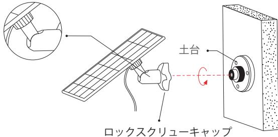
5. ソーラーパネルを左右に調整する場合は、ロッキングスクリューキャップを緩め、スリープロッドを回し、パネルが希望の位置になったらロッキングスクリューキャップを締め直してください。
