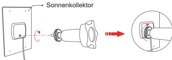
4. Schrauben Sie die Verschlusskappe in die Basis. Achten Sie darauf, dass das Kardangelenk nach oben gerichtet ist.
