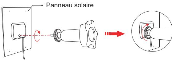
4. Vissez le bouchon à vis de blocage dans la base. Veillez à ce que le joint universel soit incliné vers le haut.
