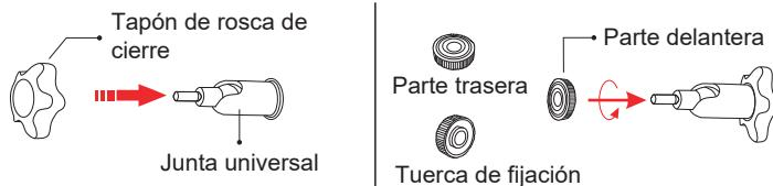
3.Atornille la junta universal en la parte trasera del panel solar. Apriétela firmemente con la tuerca adjunta.
