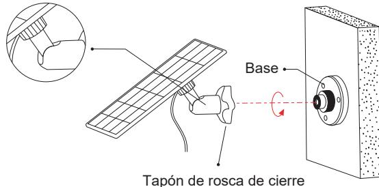
5. Cuando ajuste el panel solar a la izquierda o a la derecha, afloje el tapón de rosca de cierre, gire la varilla del manguito y vuelva a apretar el tapón de rosca de cierre cuando el panel esté en la posición deseada.
