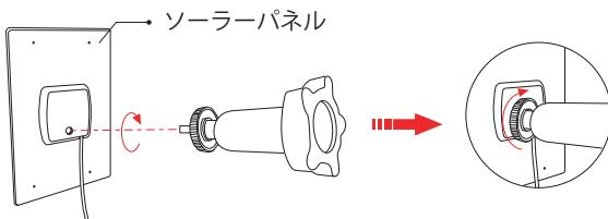
4. ロック式のスクリューキャップを土台にねじ込んでください、ユニバーサルジョイントの角度が上向きになっていることを確認してください。
