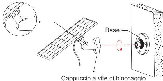
5. Quando si regola il pannello solare a sinistra o a destra, allentare il tappo a vite di bloccaggio, girare l'asta del manicotto e serrare nuovamente il tappo a vite di bloccaggio quando il pannello si trova nella posizione desiderata.
