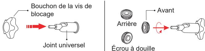
3. Vissez le joint universel à l'arrière du panneau solaire. Serrez-le fermement avec l'écrou joint.
