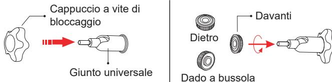
3.Avvitare il giunto universale nella parte posteriore del pannello solare. Stringilo saldamente con il dado allegato.
