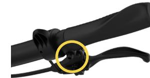
1. Verwenden Sie einen Inbusschlüssel (Hex Key #5), um die Schraube am rechten Bremshebel gegen den Uhrzeigersinn zu lösen.
