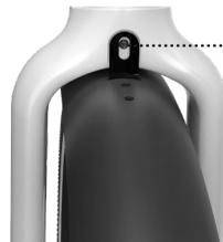
Der Kotflügel soll in einem kleinen Bereich nach oben und unten verschoben werden können.
