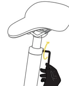
3. Ziehen Sie die Schraube mit dem Inbusschlüssel (Hex Key #5) im Uhrzeigersinn fest.
