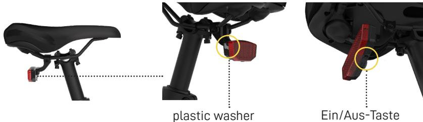
1. Vor der Verwendung, entfernen Sie bitte die Kunststoff-Unterlegscheibe aus dem Rücklicht/Reflektor, sonst wird das Rücklicht/der Reflektor nicht leuchten.
