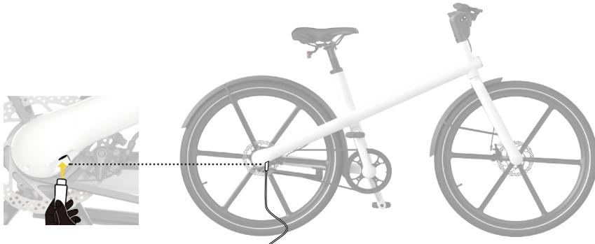
Öffnen Sie vorsichtig die Gummiabdeckung und stecken Sie den Ladestecker in die Ladebuchse. Der Ladevorgang ist in etwa vier Stunden abgeschlossen. Die Batterie ist dann vollständig aufgeladen, wenn die LED des Ladegeräts von Rot auf Grün wechselt. Wenn die Batterie leer ist, blinkt der letzte Balken der Anzeige des Batteriestands und die Batterie muss sofort aufgeladen werden.
