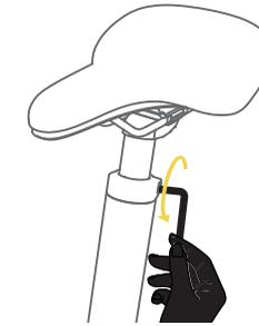
1. Lösen Sie die Klemmschraube mit dem Inbusschlüssel (Hex Key #5) gegen den Uhrzeigersinn, bis der Sattel mit wenig Kraftaufwand bewegt werden kann.
