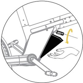
2. Sostenga la batería con la mano cuando la saque para evitar el riesgo de caída al suelo. Gire la llave en sentido contrario a las agujas del reloj para abrir la cerradura de la batería.
