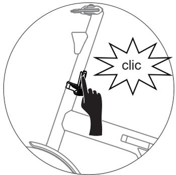
3. Presione firmemente la abrazadera de la bisagra hasta que escuche un "clic", lo que indica que la abrazadera de la bisagra está bloqueada en su lugar.
