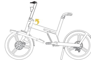
5. Voltee el vástago hacia arriba, hasta su posición vertical. Preste atención a los cables de freno para evitar daños al desplegarse. Tire de la abrazadera de la bisagra hacia abajo hasta su punto más bajo y continuar empujando el vástago a su posición vertical.
