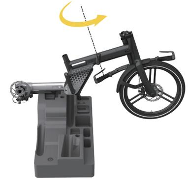
6. Saque la bicicleta de la caja, despliegue el cuadro de la bicicleta en el sentido de las agujas del reloj y colóquela sobre la espuma.
