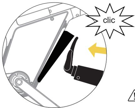
2. Después de que la parte inferior de la batería esté en su lugar, empuje la batería hacia el compartimento de la batería hasta que escuche un "clic", lo que indica que la batería está bien instalada.
