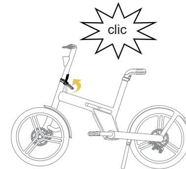
6. Suba la abrazadera de la bisagra hacia arriba y presiónela firmemente hasta que escuche un "clic", lo que indica que la abrazadera de la bisagra está bloqueada en su lugar.
