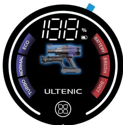
**Protection de la charge** “ **BATTERY** ” : Lorsque la tension/courant de l'adaptateur est anormale, l'icône clignote à 0,6 Hz, et le fait de cliquer sur le bouton On/Off ne marche plus.
