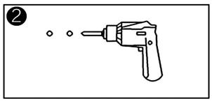
2.USE THE M6 BIT TO PUNCH HOLES IN THE MARKED POSITION
