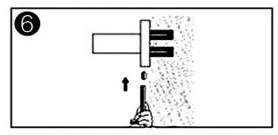
6.SCREW THE BASE POSITION WITH WRENCH OF THE DISTRIBUTION
