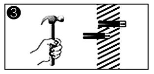
3.USE THE HAMMER TO PUSH THE PLASTIC EXPANSION PIPE INTO THE HOLE
