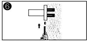
6.SCREW THE BASE POSITION WITH WRENCH OF THE DISTRIBUTION
