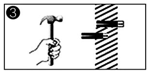
3.USE THE HAMMER TO PUSH THE PLASTIC EXPANSION PIPE INTO THE HOLE
