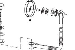
7、安装排水管: 依排水管的安装说明书将排水管安装在浴缸 上。下图是推荐使用的我司排水管P9098N的安装图例。
