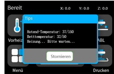
Das System wird nach dem Erhitzen automatisch nivelliert
