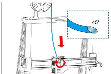
Um das Filament reibungslos zuzuführen, halten Sie das Ende des Filaments bitte bei 45°
