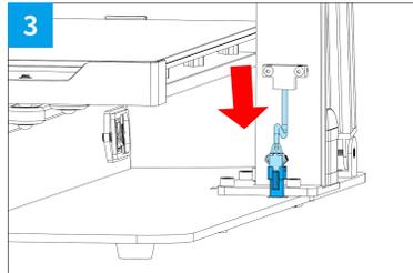
Filament detector | Filamentdetektor
