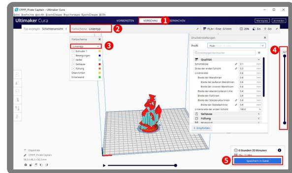
1. Nachdem der Schnitt abgeschlossen ist, können Sie die Zeit und das Gewicht des Materials anzeigen, das für den Druck benötigt wird;
