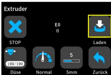
Klicken Sie auf „Laden“, um das Filament zuzuführen, bis das Filament aus der Düse heraus ist.
