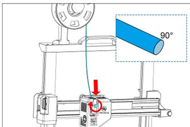
Um das Filament reibungslos zuzuführen, halten Sie das Ende des Filaments bitte bei 90°
