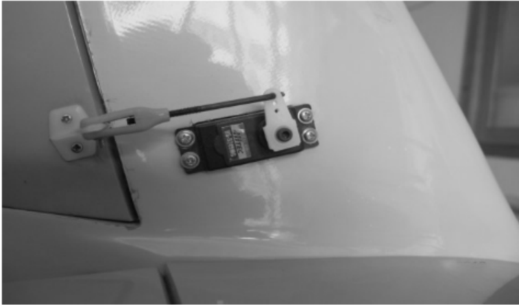
安装垂直尾伺服 Install vertical tail servo
